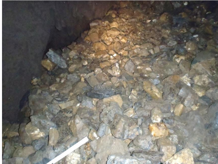
Abbildung 4-21 Versatz (rückverfüllter Abbaubereich, Grube San Fernando (Foto: POHL 2011)
