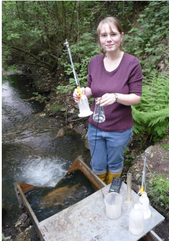
Abbildung 4-4 Probenahme (Titration) am Auslauf der Grube Wolf (Foto: PORR 2011)
